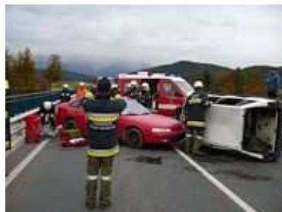
Als Erstes wurde die Batterie abgeklemmt und das Fahrzeug unterkeilt, damit der Fahrer nicht unnütz durch Erschütterungen weiter verletzt wird. Danach wurde die Windschutzscheibe herausgeschnitten. Mit Schere und Spreitzer wurde die A, B und C Säule durchtrennt und dann das Dach unten kurz eingeschnitten, damit man es leicht nach unten drücken konnte. Nachdem dies alles erledigt war wurden die entstandenen scharfen Schnittkanten abgedeckt und der Bergetrupp machte Platz für die Sanitäter.
