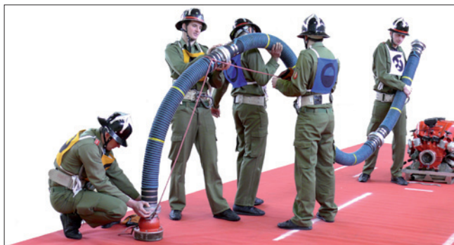
Abb. 33: Richtiger Leinenschlag vor jeder Saugschlauchkupplung.
