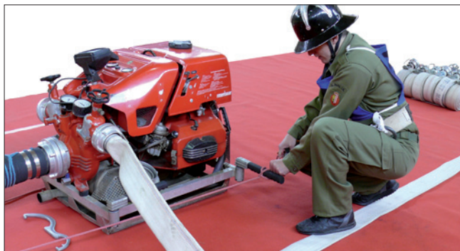
Abb. 38: Richtiges Befestigen der Saugschlauchleine.
