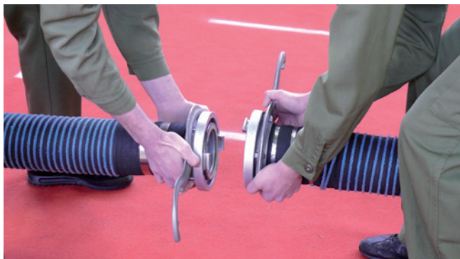
Abb. 29: Kuppeln der Saugschläuche mit angesetzten Kupplungsschlüsseln.
