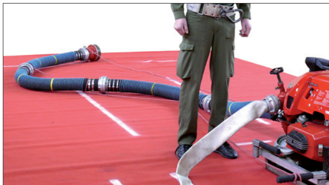
Abb. 40: Richtiges Ablegen einer fertigen Saugschlauchleitung.
