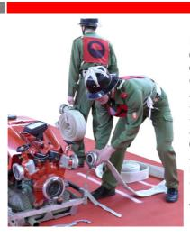
Nach dem Angriffsbefehl nehmen der Angriffstruppführer (1) und der Angriffstruppmann (2) je einen B – Schlauch. Der Angriffstruppmann (2) öffnet den Schlauchträger seines B – Schlauches und kuppelt diesen an den rechten Druckausgang der Tragkraftspritze an. Der Angriffstruppführer (1) ergreift nun den auszulegenden B - Schlauch an der freien Kupplungshälfte und zieht diesen vorschriftsmäßig in Richtung Brandobjekt aus.
